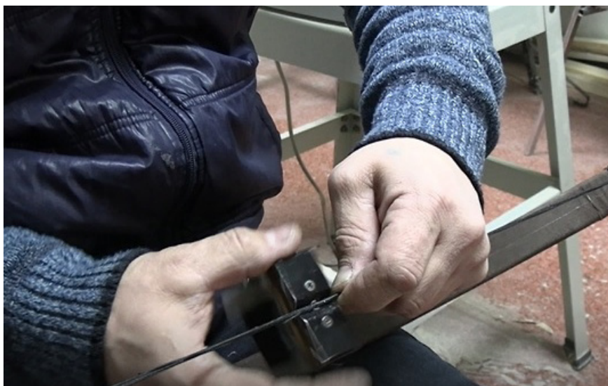
Фото 6. Обмотка тетивы посередине обмоточной машиной.
