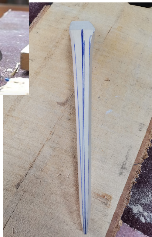
Фото 4. Заготовка плеча после выравнивания. Фото С. Н. Куулар, 2023. Архив ЦРТТКР. Photo 4. Shoulder preparation after alignment. Photo by S. N. Kuular, 2023. CRTTKR archive.
